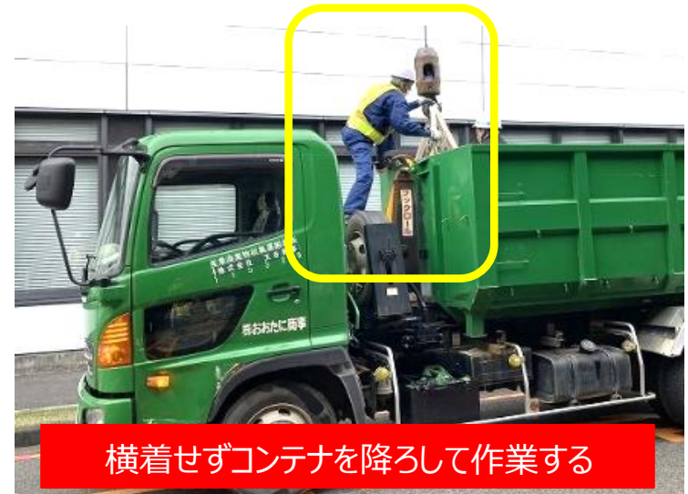
事例：コンテナ上での不安定作業・昇降設備不良
